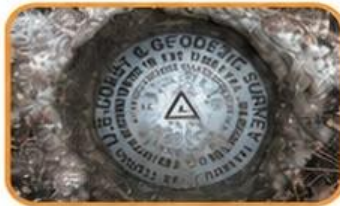
أعمال شبكات الضبط
